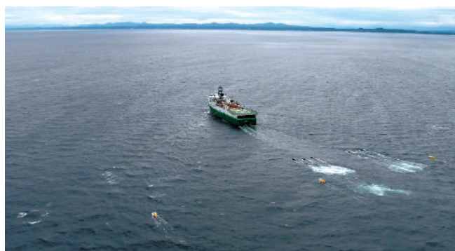
船舶による弾性波探査の様子
