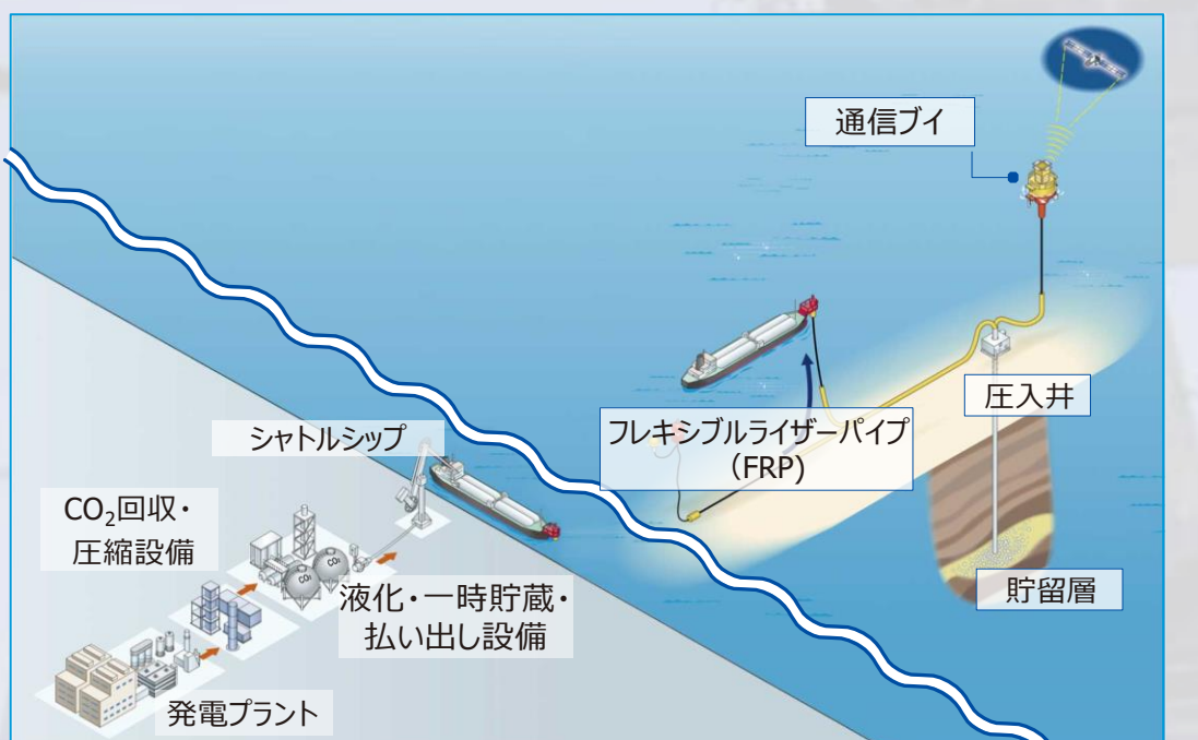
CO 2 の船舶輸送と海底下への圧入（シャトルシップシステムの例） （図提供：千代田化工建設・東京大学）
